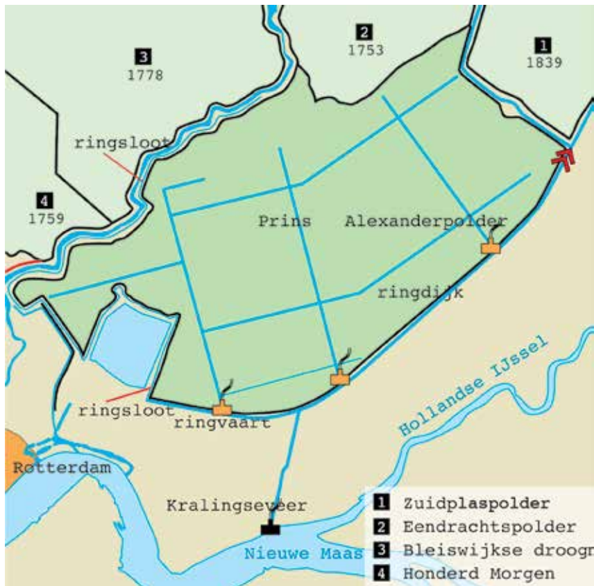
14 | Tekening met schematische weergave van de droogmakerij met ringvaart en 4 gemelen
